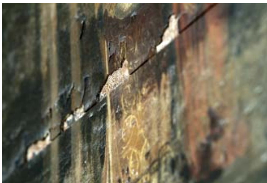
Exemple de détérioration due à la lumière : cette peinture sur bois reçoit directement la lumière du soleil. Le bois sèche, se fend ; la peinture se craquelle, se décolle et se détache.
